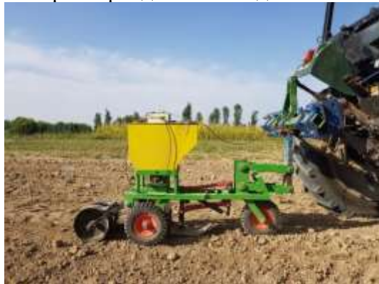
1-расм. Пахта чигити билан соя уруғини бир вақтда экувчи сеялка секциясининг қаршилигини аниқлаш ҳолати
