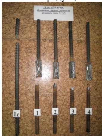
Рис.1. Вид сварных соединений Ø 25 мм после испытания
