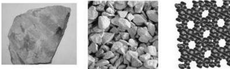
Рис. 1. Внешний вид цеолита и его микропористая структура
