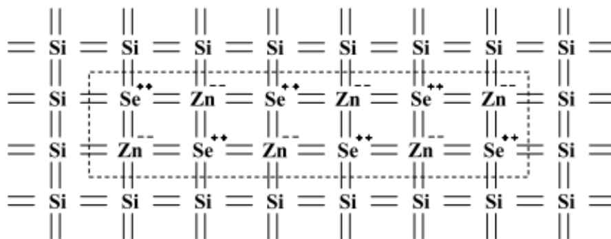
5-расм. Кремний панжарасида \text{Zn}^-\text{Se}^{++}(\text{A}^{\text{IV}}\text{B}^{\text{VI}}) типидagi БЭЯ лардан таркиб топган нанокластерларнинг жойлашиши
